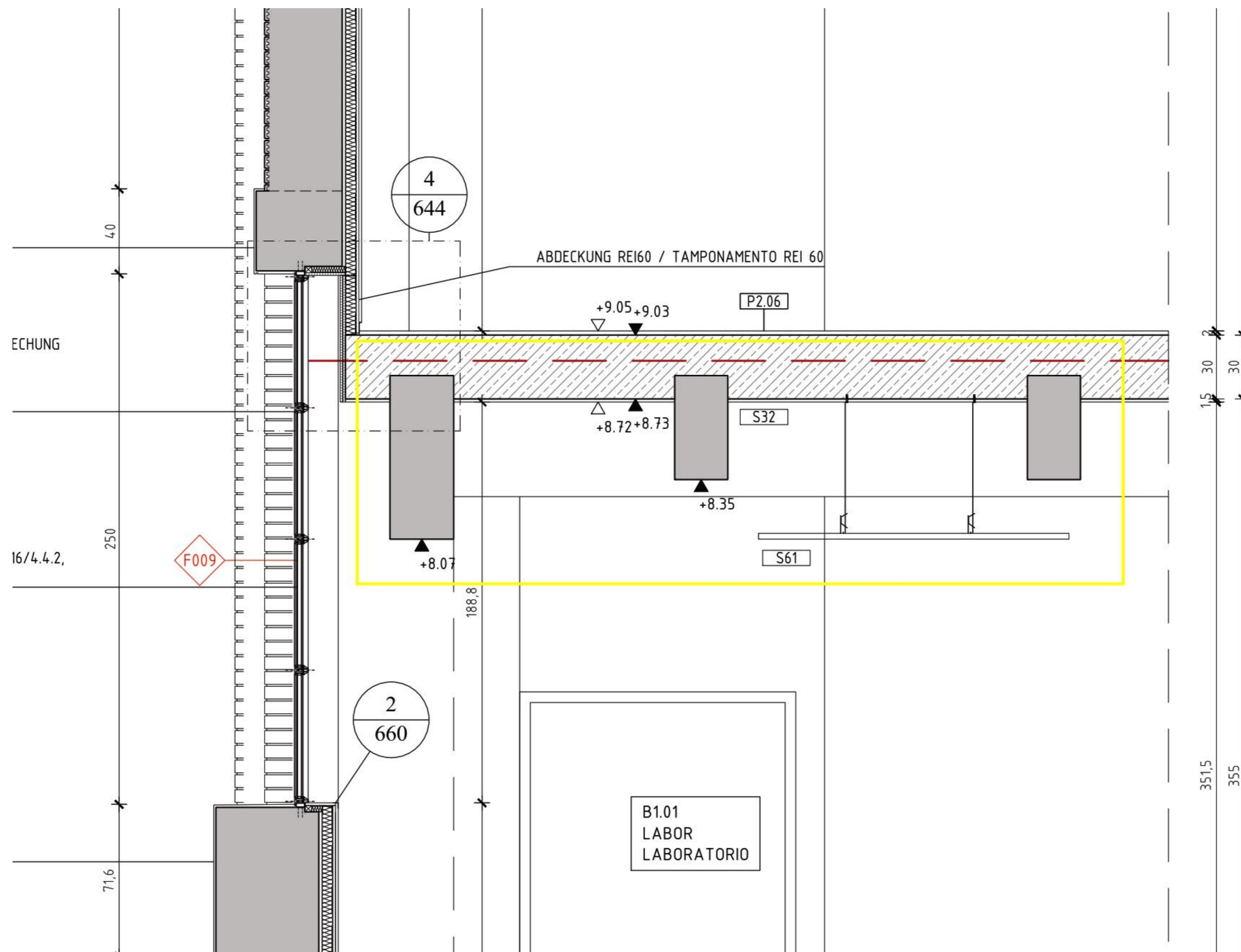
**Auszug aus Statikplan S613: Verlegung der unteren Bewehrung wäre im Bereich der Bestandsträger nicht wie geplant möglich:**
