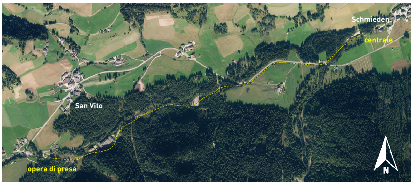
Impianto idroelettrico con opera di presa sul rio Braies e centrale
